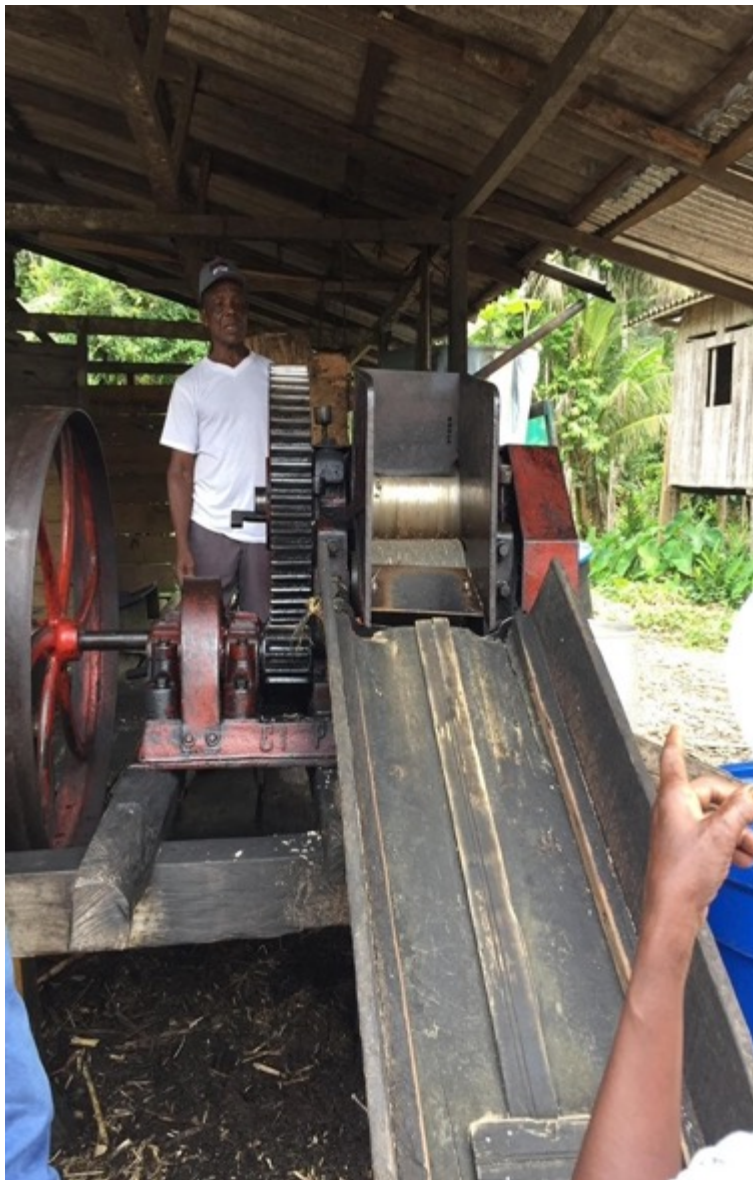
Foto 7 Trapiche mecánico en la cuenca del río Cajambre, Buenaventura, Valle del Cauca.
