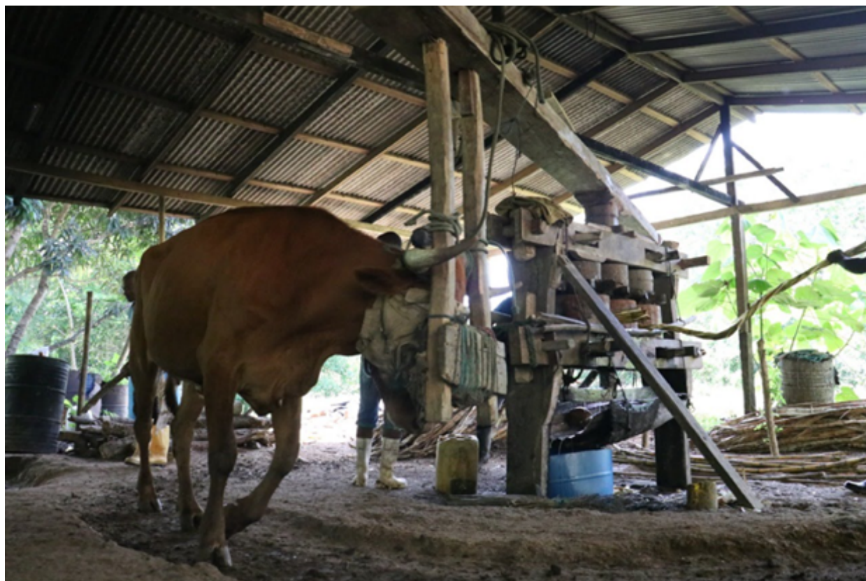
Foto 8 Trapiche movido con tracción animal en la vereda de Soledad de Curay, ensenada de Tumaco, Nariño
