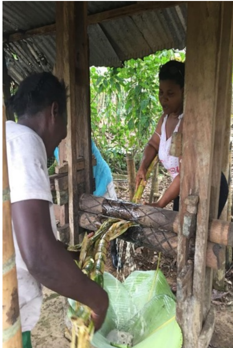
Foto 6 Trapiche manual o “matacuatro” usado en el Consejo Comunitario Callelarga en la vereda Palmeras, Buenaventura, Valle del Cauca.
