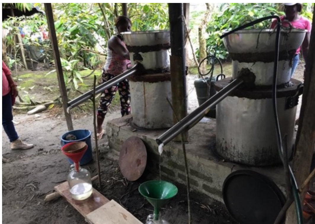
Foto 11 Alambique artesanal tradicional en la cuenca del río Cajambre, Buenaventura, Valle del Cauca
